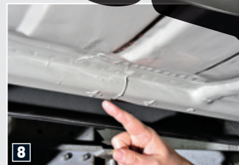
8 MESSPUNKTE Die Kreuze am Bodenblech sind im Zuge einer Restaurierung oft verschwunden
