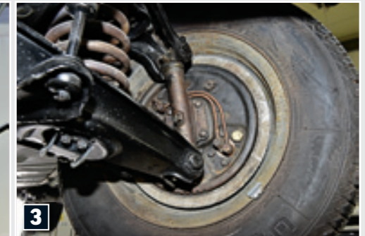
3 BREMSE Die Wartung der Trommelbremsen wird aufgrund des höheren Aufwands oft vernachlässigt
