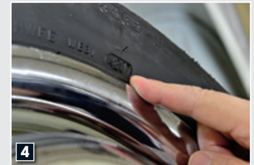
4 REIFEN Da ein SL meist wenig gefahren wird, sind häufig gut profilierte, aber uralte Reifen montiert
