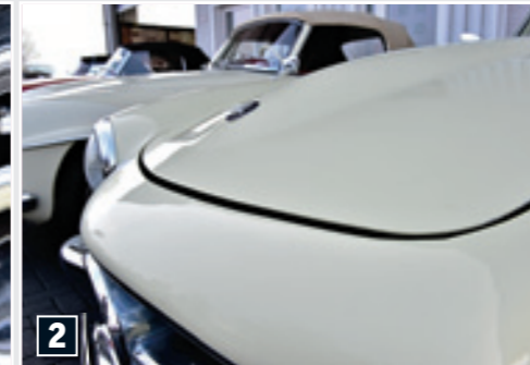
2 SPALTMASSE Ein zu breiter Spalt zwischen Haube und Frontmaske deutet auf Ersatz oder Reparatur hin
