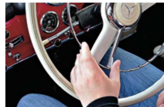
Bei deutschen Fahrzeugen wird der Blinker über den Hupring bedient, bei US-Modellen kommt der Hebel links zum Einsatz
