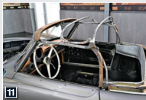
11 VERDECK Je nach Gebrauch leidet der faltmechanismus – sofern das Verdeck nicht sogar komplett fehlt
