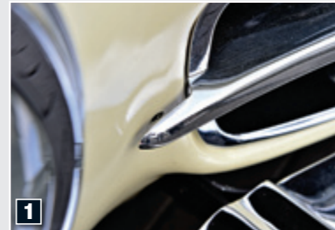
1 PASSGENAUIGKEIT Die Strebe des Kühlergrill-Einsatz sollte sich dicht ans Blech schmiegen
