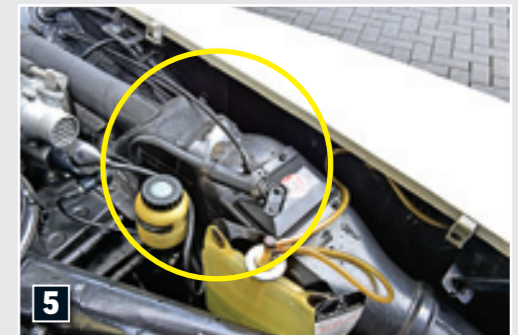
5 HEIZUNG Der originale Heizungskasten aus Presspappe ist oft vergammelt oder bereits ersetzt
