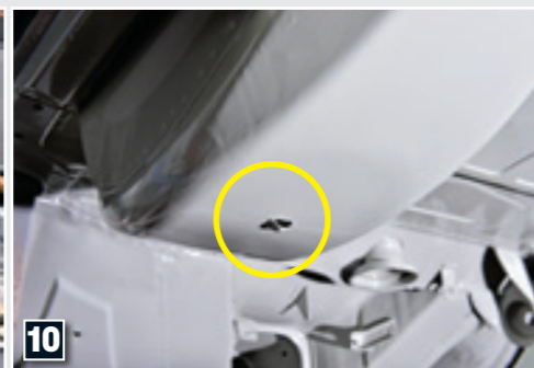
10 RESERVERADMULDE Anstelle der nach hinten weisenden Abläufe gibt es häufig einfache Bohrlöcher
